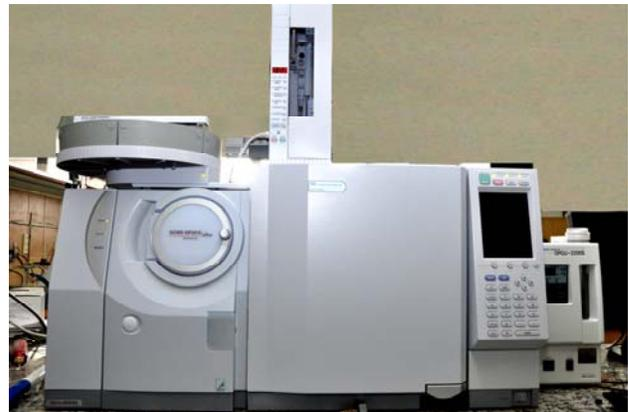
Cromatógrafos gaseosos con detectores selectivos de masas, con sus respectivos automuestreadores automáticos.
