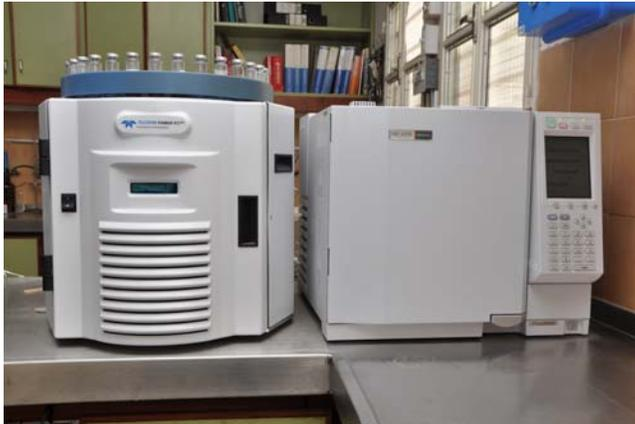
Cromatógrafo gaseoso con automuestreador de espacio cabeza, para análisis de etanol y otros compuestos volátiles
