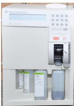
Para la investigación, de una intoxicación con monóxido de carbono, el laboratorio dispone de un Cooximetro, un sofisticado equipo que con muy poca cantidad de sangre, permite determinar la cantidad de carboxihemoglobina de un individuo y por ende su grado de intoxicación.
